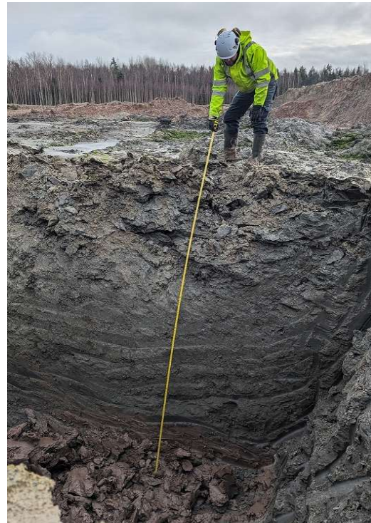
Foto 4.10. Kaevandis K-6 Q 3,2 m (lasumi abs 7,63 m). Varasematel andmetel lasumi abs ~11,5 m. Tegelik Q ~4 m suurem. (N 58°03'30" ja E 24°31'47").
